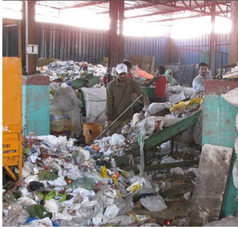
Phụ lục 11.1. Tuyển chọn vật liệu tái chế theo cách thủ công tại một cơ sở thuộc thành phố Pune, Ấn Độ
